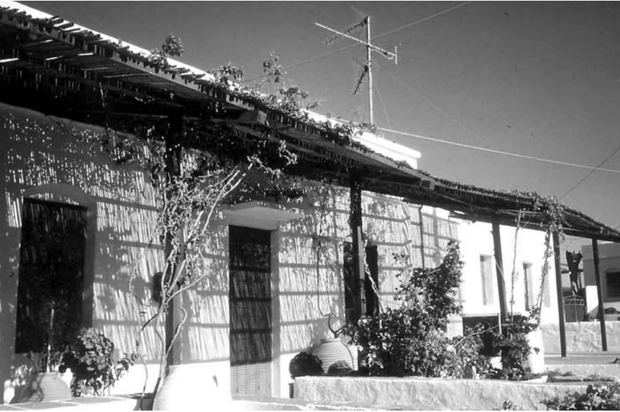
Bild 55 Pergolastruktur zur sommerlichen Beschattung einer Südfassade und Terrasse in der einfachen Inselarchitektur Griechenlands
